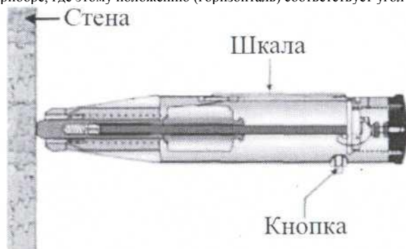
Рисунок 2.1 - Положения прибора во время проведения испытания
